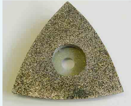
Diamant-Schleifdreieck , zum Ecken Schleifen bei mineralischen und Kunststoff-Oberflächen etc. Art.-Nr. 225.015 grob (K 30/35) Art.-Nr. 225.016 fein (K 50/60)
