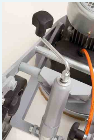
Mittels Spindel kann die Führungsstange für jeden Bediener individuell in der Höhe eingestellt werden
