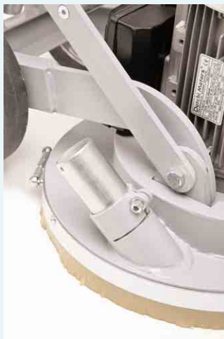
Der austauschbare Absaugstutzen (Verschleißteil) ist justierbar, um optimale Absaugwirkung zu erreichen.
