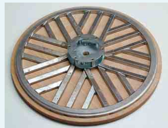
Holzabreibeischeibe zum Abreiben von Gussasphalt
