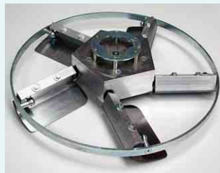
Flügel-Glätteteller Ø 600 mm mit Metall- oder Kunststoffflügeln zum Glätten von Zement- und Anhydrit-Estrichen und Beton
