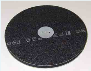
Schleifteller mit flexibler Unterlage für Papier doppelseitig und Hartmetallschleifscheibe
