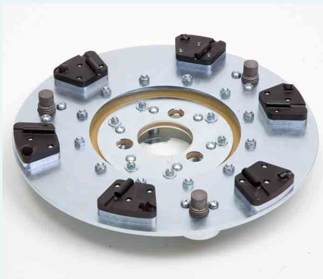
Trägerteller PKD, gepuffert, Ø 400 mm, mit 6 PKD-Segmenten und Frästiefenregulierung. Abtragen hartnäckiger Kleber aller Art (PU-, Bitumen-, Kunstharz-, etc.) und Spachtelmasse, abfräsen von Estrich, Fliesenkleber. Äußerst effizient bei hoher Standzeit.
