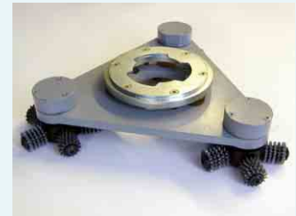
Trägerteller WCT, gepuffert, Ø 425 mm, mit 3 drehbar gelagerten Fräsköpfen WCT spitz 2,5 mm für dünne Kleber, Farbanstriche, auch auf Holzböden. Oder WCT spitz 4 mm für Kleber, Spachtelmasse auf ganz weichen Estrichen.
